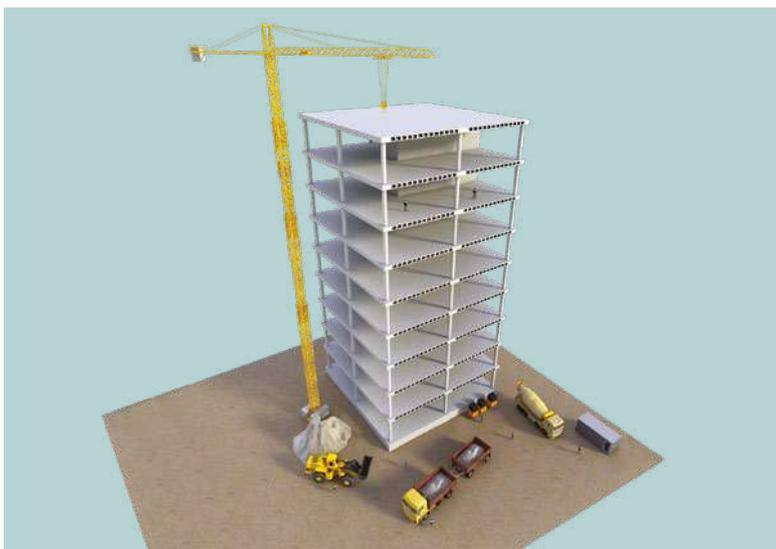
Alleggerire la struttura dell'edificio migliorandone la risposta sismica e riducendo il consumo di calcestruzzo e ferro: le casseforme per solai Geoplast sono molto veloci da installare sia per solai mono che bidirezionali.
