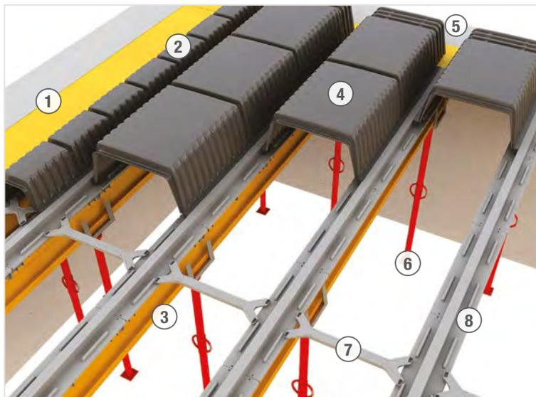
Skyrail è un sistema completo in grado di coprire tutte le esigenze di cantiere. Grazie ad una accessoristica completa, permette compensazioni sia laterali che longitudinali. La puntellazione risulta estremamente semplice con l'utilizzo di puntelli e travi d'armo.
