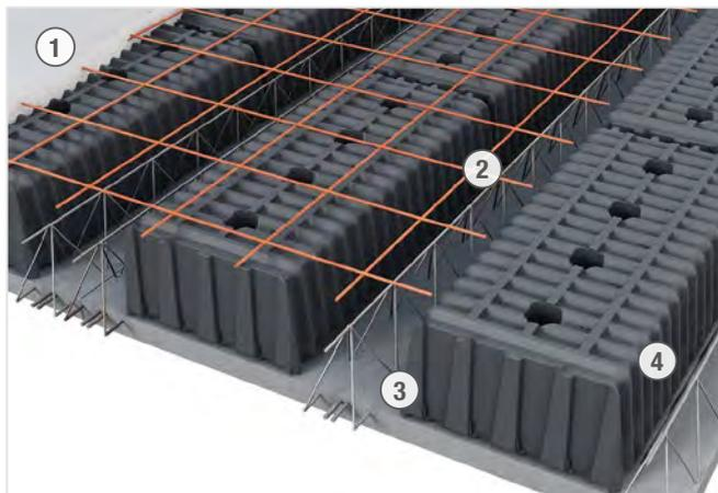
Il cassero Airplast si presta in maniera ideale all'accoppiamento alle lastre prefabbricate. Gli elementi vengono alloggiati sul calcestruzzo fresco in stabilimento e le lastre vengono trasportate in cantiere pronte per essere posate. Rispetto all'EPS mantiene la stessa operatività.
