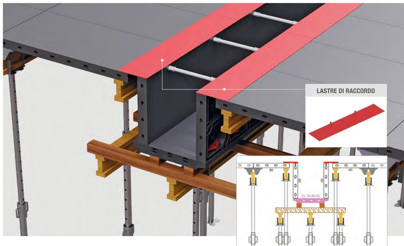
Lastre di raccordo per collegare il piano di cassetatura solaio al cassero della trave.
