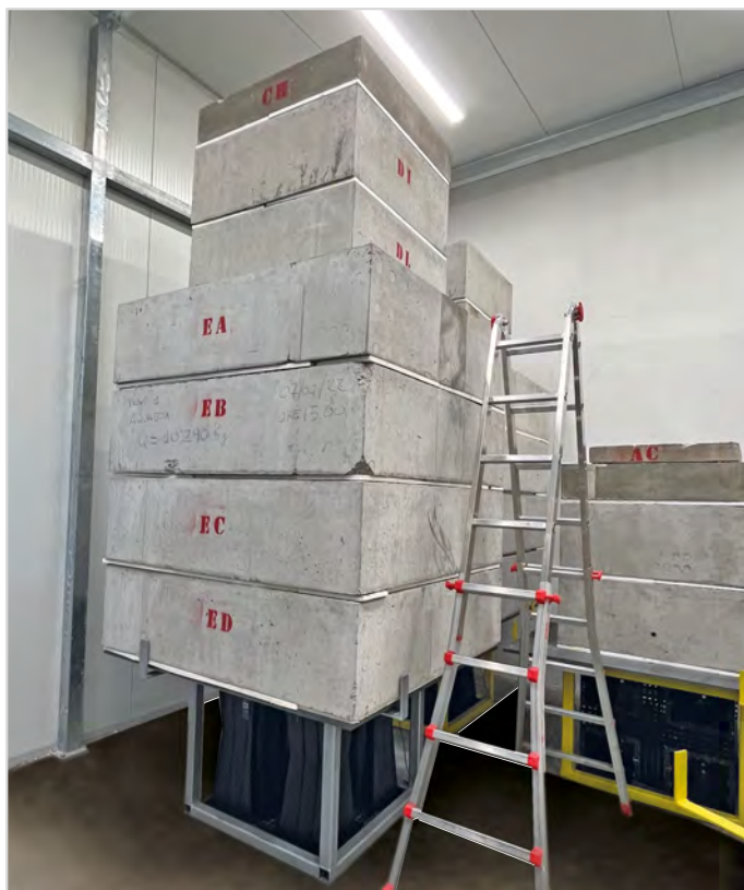
Provini di calcestruzzo per prova di carico Aquabox
