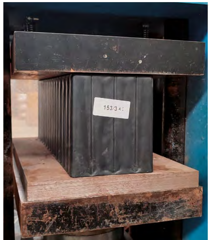
Test di resistenza del nuovo elemento in polipropilene
