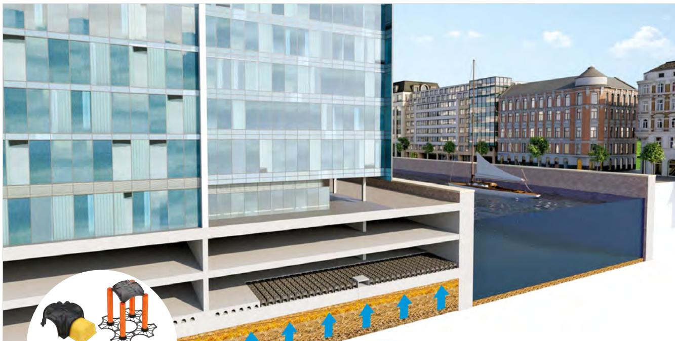
Nel caso di platee di fondazione sottoposte a pressione di acqua di falda, è opportuno prevedere un'intercapedine di drenaggio fra la platea e la pavimentazione per intercettare eventuali infiltrazioni d'acqua ed evacuarle per mezzo di pompe.
