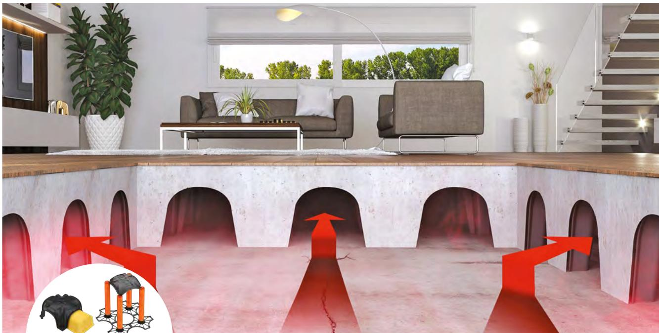
Realizzare una intercapedine ventilata non aiuta solamente ad attenuare l'umidità di risalita. Molti terreni infatti emettono naturalmente gas radon, radioattivo e cancerogeno; altri ancora metano o diversi gas tossici. Grazie alla ventilazione naturale che si innesca nel vespaio Modulo e Elevator, si crea una barriera naturale che impedisce a questi gas di entrare nell'edificio. L'unica accortezza da seguire è la creazione di condotti di ingresso e di uscita di aria esterna.
