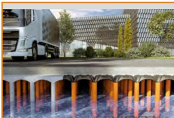
Modulo ed Elevator permettono la creazione di bacini di raccolta acqua all'interno di edifici, senza limiti di carico utile.
