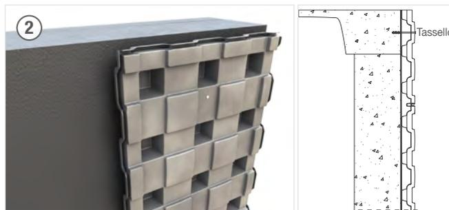
In prossimità del cordolo del solaio, fissare il pannello più alto con un tassello (preferibilmente chimico e non meccanico).
