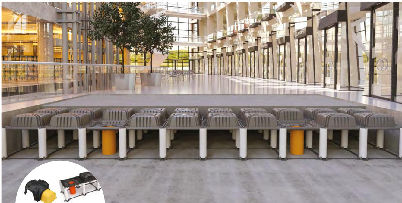
Se si intende realizzare un solaio in una situazione in cui è difficile se non impossibile recuperare la puntellazione ed il fondo di cassetteria, Modulo e Skynet possono essere utilizzati come puntellazione e cassetteria a perdere. In questo caso i piedini non sono riempiti di calcestruzzo, bensì tappati con un materiale economico e sufficientemente resistente per sostenere il peso del calcestruzzo.
