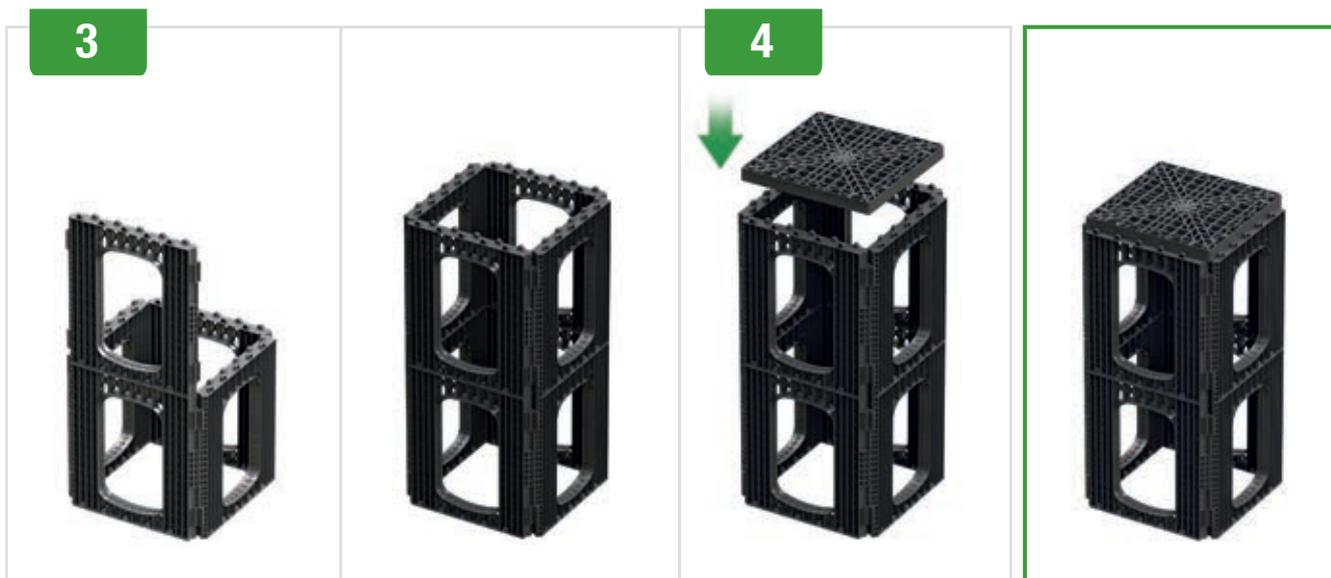
Se previsto, installare le pareti dei livelli Rootbox superiori. Il loro bordo superiore è dotato di speciali rilievi per garantire un accoppiamento sicuro e bloccare qualsiasi movimento laterale. Assemblare le pareti laterali sfruttando l'aggancio a slitta già descritto.
