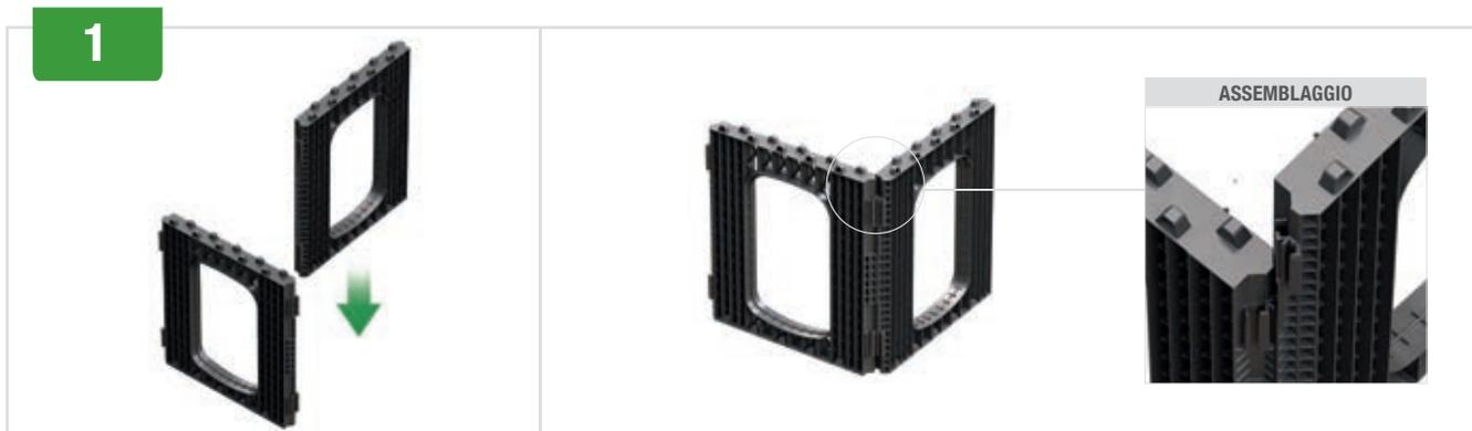
La struttura verticale di Rootbox si compone di un solo elemento verticale universale che compone le pareti del sistema. Facendo scorrere il perno maschio nell'alloggiamento femmina della parete da collegare, gli speciali agganci a slitta permettono un accoppiamento semplice e solido.
